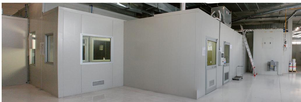
**2 – L'impianto per la preparazione e l'applicazione delle finiture (base colore e trasparente). L'accesso alle due linee si effettua attraverso porta doppia (con doccia d'aria ionizzata temporizzata) e clean room di controllo cabine.**
