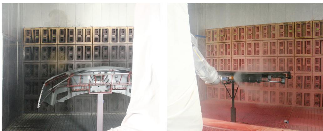
**7 e 8 – Le cabine d'applicazione della linea di finitura. La filtrazione è a secco, l'applicazione robotizzata. Le cabine automatiche sono a ricircolo d'aria, per minimizzare i costi energetici.**
